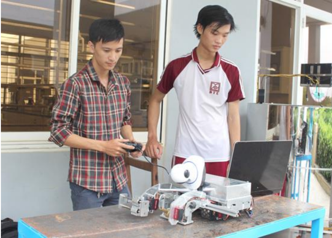
Hai thành viên trong nhóm cùng Robot kiểm tra mối hàn vỏ tàu
