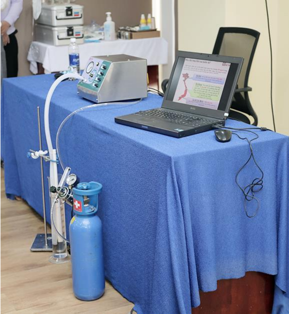
Máy trợ thở DTU-Vent được thiết kế với 10 chế độ được cài đặt sẵn thông qua ước lượng chiều cao của bệnh nhân. Ảnh: AN
