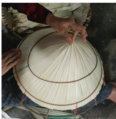
Hình 6. Công đoạn cố định vòng phụ cho lá phẳng để chuẩn bị chằm nón
