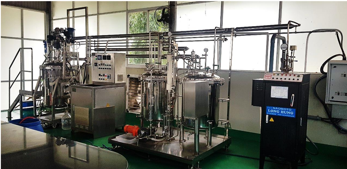
Hình 1. Hệ thống lên men VA-FCP 300
