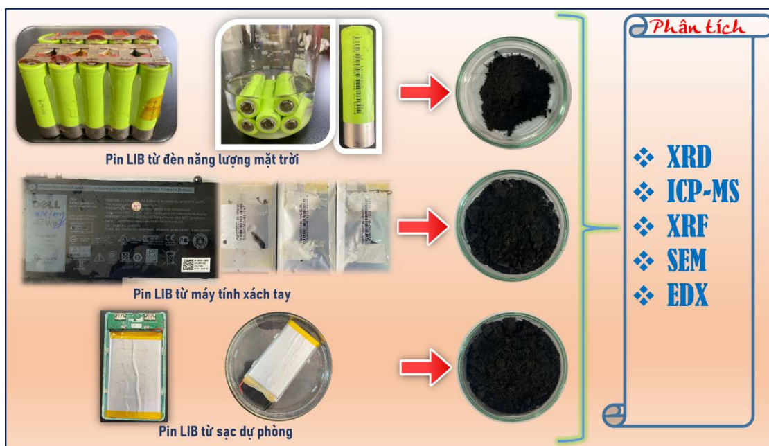
Hình 1. Nguồn pin LIB thải từ các thiết bị điện tử khác nhau và các phương pháp phân tích đặc trưng
