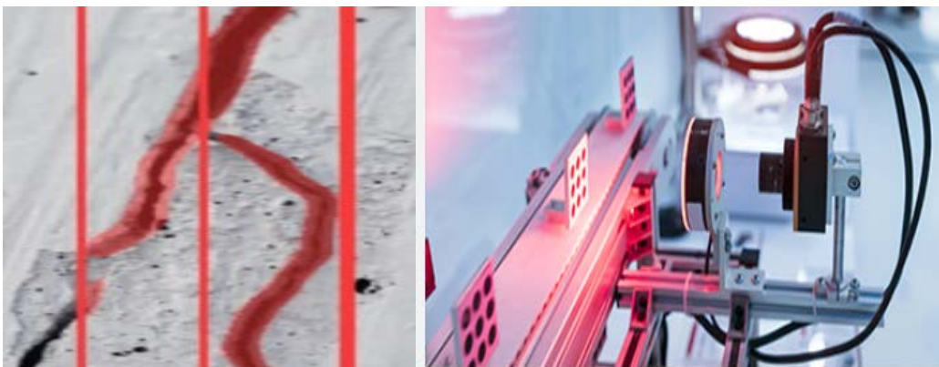
Hình 1. Áp dụng thị giác máy tính phát hiện khuyết tật thông qua xử lý ảnh
