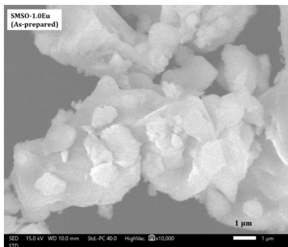
Hình 2. Ảnh SEM của mẫu SMSO-1.0Eu sau khi chế tạo (As-prepared).
