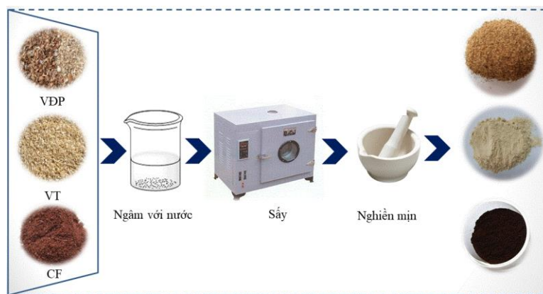
Hình 1. Quy trình thu nhận vật liệu VDP, VT, và bã CF
